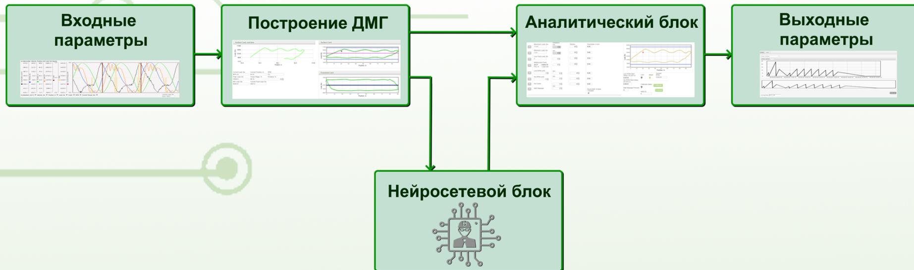
Блок нейросети «Цифровой технолог» является дополнением и альтернативой аналитических алгоритмов, также применяемых в контроллере Wellsim. Он позволяет решить задачу диагностики, повысить точность расчетов и производить постоянный мониторинг состояния скважины.
