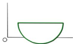
Износ неподвижного клапана
